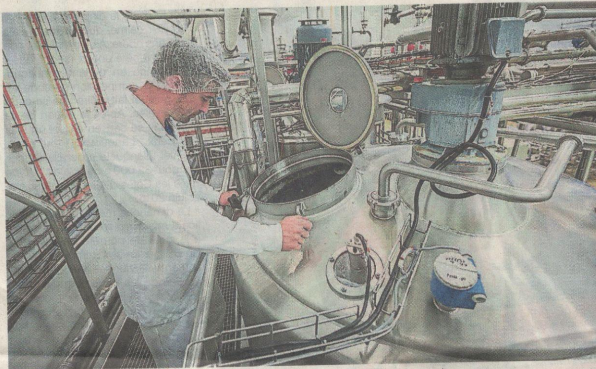
La nouvelle conditionneuse d'Ovoteam peut conditionner 6 tonnes d'œufs liquides par heure.
